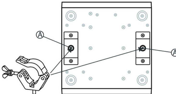
A Filetages pour adaptateurs de montage aérien (demi-coupleurs, colliers d'ancrage, crochets en C, etc.)
