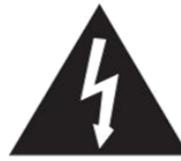
Le symbole de l'éclair fléché dans un triangle équilatéral, est destiné à alerter l'utilisateur de la présence d'une "tension dangereuse" dans l'appareil qui peut être suffisante pour constituer un risque de choc électrique pour les personnes.
